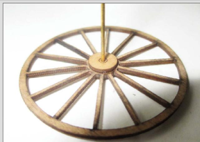
MONTAGE de l'AXE sur le MOYEU de la ROUE
