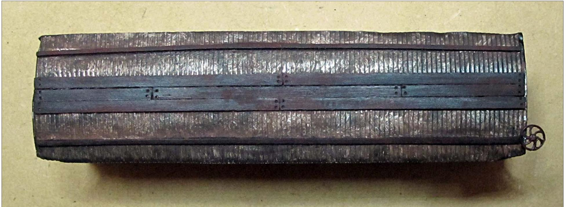
Former le toit à partir de la plaque métallique ondulée fournie. La taille nominale est de 86,5 x 21,5mm
