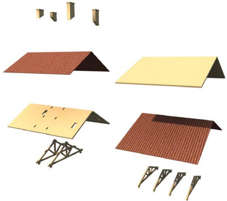
Préparer la toiture en collant les deux charpentes sur les deux toitures ou dans les logements prévus à cet effet dans le haut des façades de la gare. Les tuiles sont réalisées en Redutex en tuiles mécaniques.
