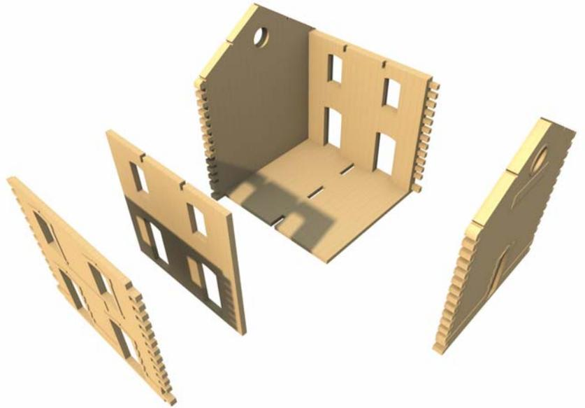
Assembler le corps de la gare en emboîtant les côtés avec les façades. Celles-ci comportent une plaque intérieure et une façade détaillée.
